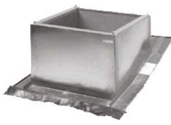
Taksocket SDS för tak med takpannor, av förzinkad stålplåt, värme och ljudisolerad. Klarar av taklutning upp till 30°. *
